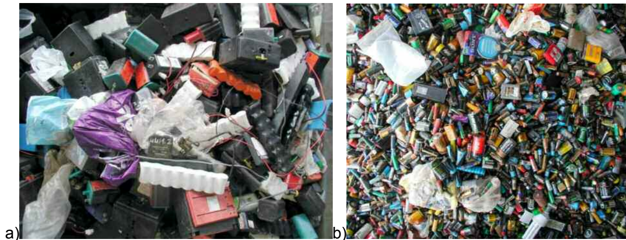
Abbildung 8 a) Große Packs, nur visuell/manuell zu sortieren; b) Grundsätzlich automatisch sortierbare Einzelzellen
